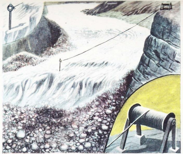
Pour mesurer la vitesse de descente des glaciers, on emploie le criocinémagraphe, constitué par une ancre fichée dans la glace et reliée à un câble d'acier qui s'enroule autour d'un cylindre fixé sur la terre stable.
